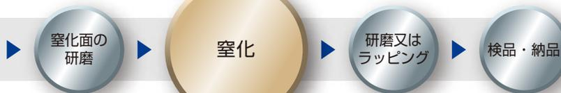
仕上り0.02~0.05mmを残して研磨します。
