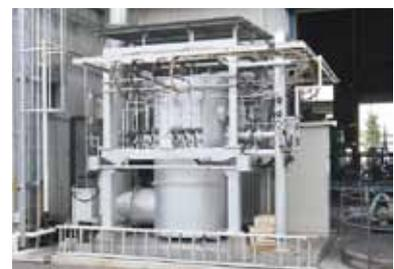
排アンモニアガス脱臭・燃焼装置
