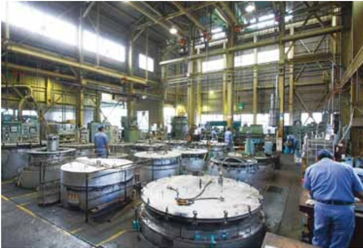
1号炉(有効寸法:直径2,180mm×長さ2,050mm)
